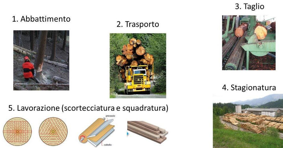
Figura A.2: Ciclo di produzione del legno
